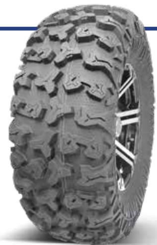
Ikke retningsbestemt mønster. Radial stamme og lav rullemotstand for mer motstandsdyktighet mot støt, og for behageligere kjøring. Meget bra "All Terrain" dekk. Ikke godkjent for vei. Dekkene kan pigges.
