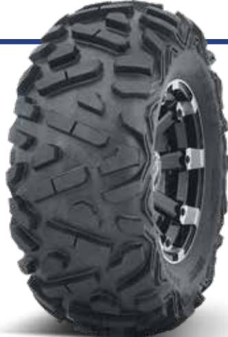
Grov off road dekk til de fleste 4x4. Kraftige skulderribber for å beskytte sideveggene, samt ekstra trekk kraft. 20mm mønsterdybde. Dekket er e-merket og godkjent for gatebruk. J-merket for 100 km/t. Vi anbefaler dette dekket til de som kjører aller mest off road, og ikke så mye på vei. Dekkene kan pigges.
